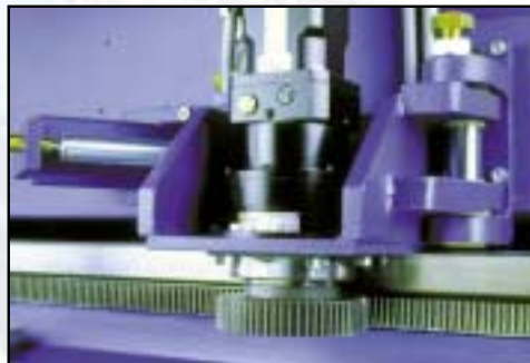
AC Antriebe bis 35 m/min Geschwindigkeit mit hoher Beschleunigung
