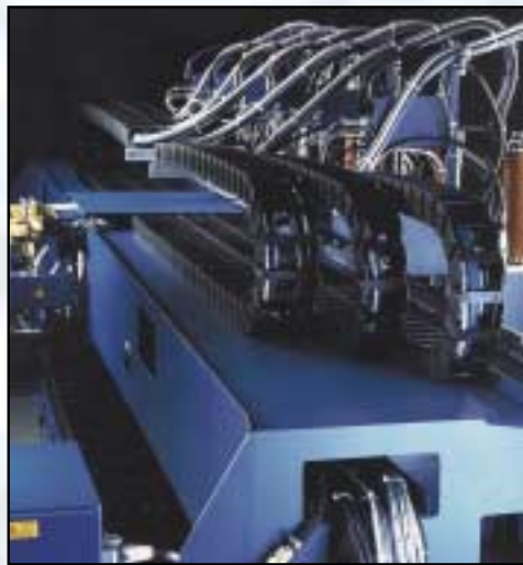
Die geschweißte Brücke wurde mit Hilfe modernster CAD Werkzeuge konstruiert und stellt ein Optimum an Dynamik und Stabilität dar
