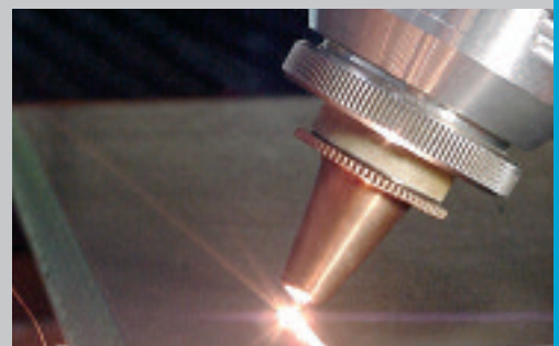
Fasenschneiden bis 45° (50°) zur Schweißkantenvorbereitung Bevel cutting up to 45° (50°) for weld preparations
