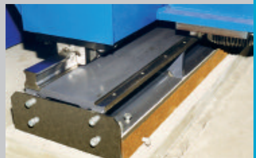
Hochgenaue Linearführung in Längs- und Querrichtung kombiniert mit wartungsfreien AC-Motoren sorgen für Schnelligkeit und Präzision High accuracy linear guides for longitudinal and transverse motion combined with maintenance free AC motors ensure speed and precision
