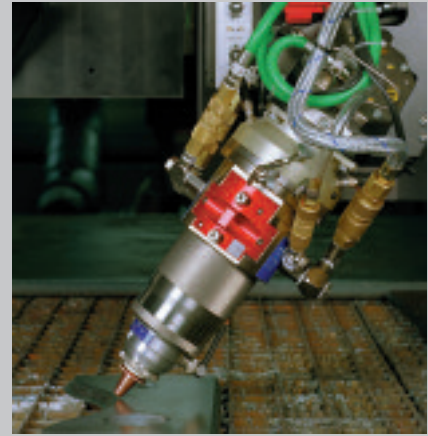
Kontinuierliche Fasenverstellung bis 50° Continuous Beveling up to 50°
