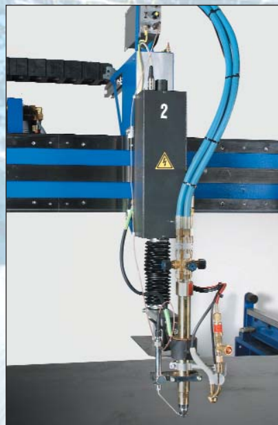
Hohe Zuverlässigkeit durch gekapselte Brennerwagen.
